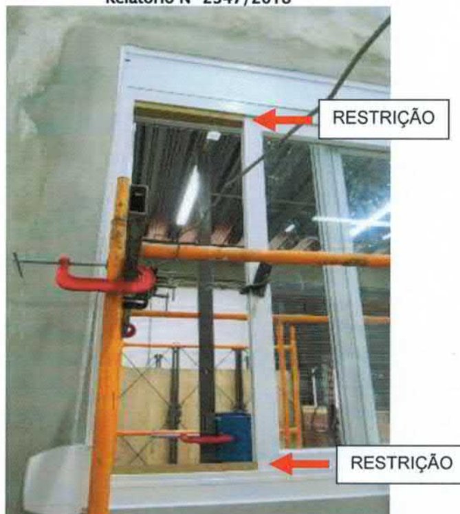
Figura 7 – Instrumentação de ensaio de resistência horizontal com dois cantos imobilizados
