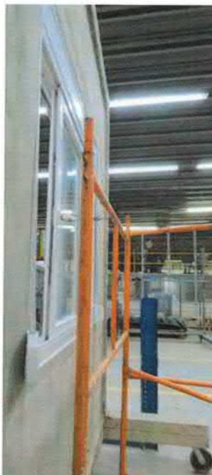
Figura 11 – Comportamento da folha interna da esquadria (400 N)
