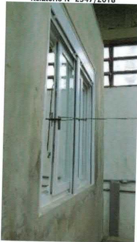
Figura 12 – Comportamento da folha externa da esquadria (400 N)
