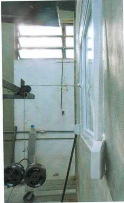
Figura 10 – Comportamento da folha interna da esquadria (400 N)
