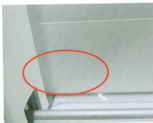
Figura 9 – Ocorrência de Permeabilidade Inicial por ocorrência de bolha durante os 30 segundos iniciais com 300 Pa
