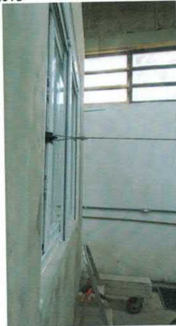
Figura 11 – Comportamento da folha externa da esquadria (400 N)
