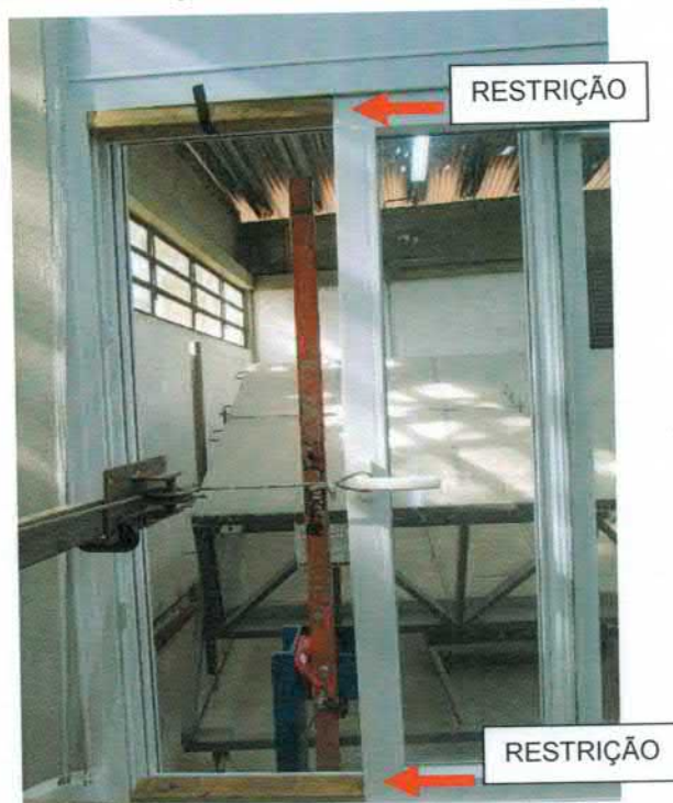
Figura 7 – Instrumentação de ensaio de resistência horizontal com dois cantos imobilizados
