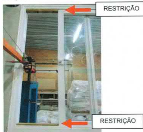
Figura 10 – Instrumentação de ensaio de resistência horizontal com dois cantos imobilizados
