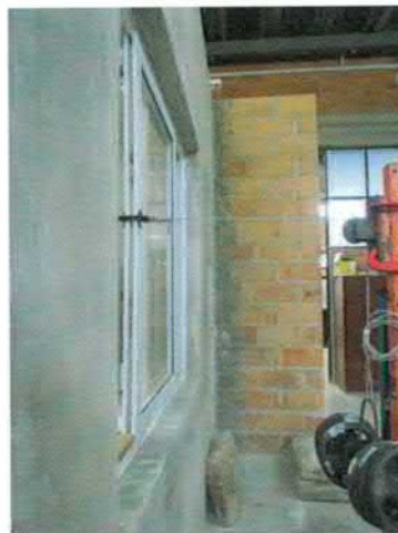
Figura 12 – Comportamento da folha externa da esquadria (400 N)
