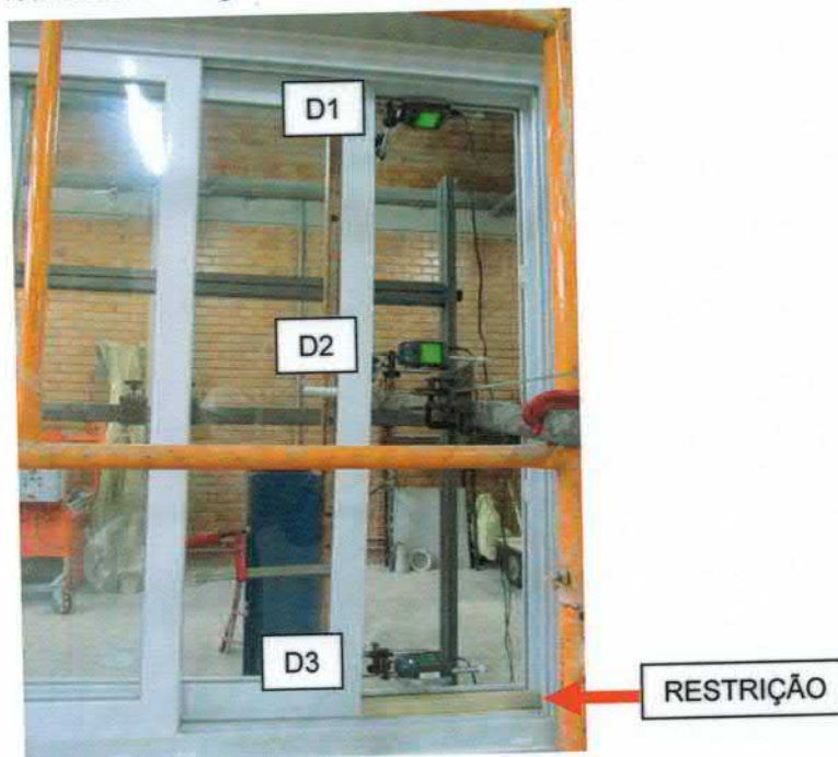
Figura 8 – Instrumentação de ensaio de resistência horizontal com um canto imobilizado
