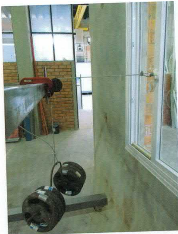
Figura 10 – Comportamento da folha interna da esquadria (400 N)
