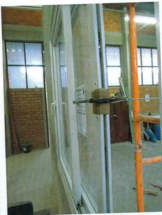
Figura 11 – Comportamento da folha externa da esquadria (400 N)
