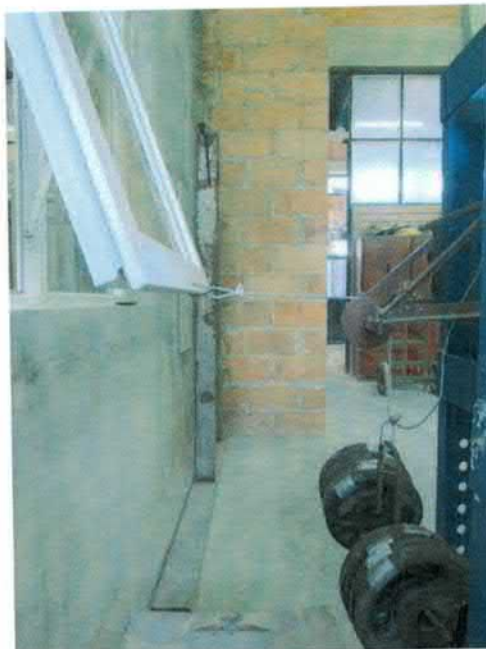
Figura 9 – Carregamento máximo (400 N) no sentido de dentro para fora
