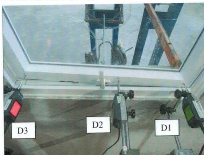
Figura 6 – Deformação máxima do perfil quando submetido ao esforço torsor
