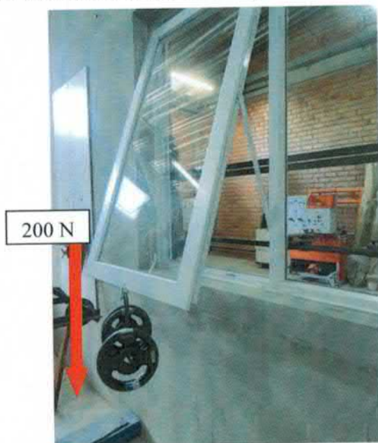
Figura 7 – Realização do ensaio de arrancamento das articulações
