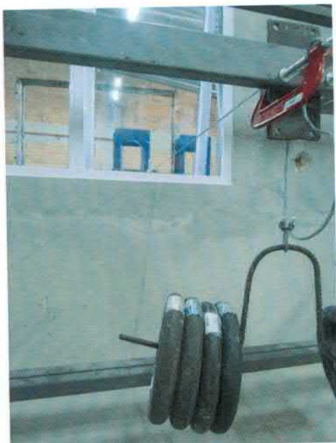
Figura 8 – Carregamento máximo (400 N) no sentido de fora para dentro
