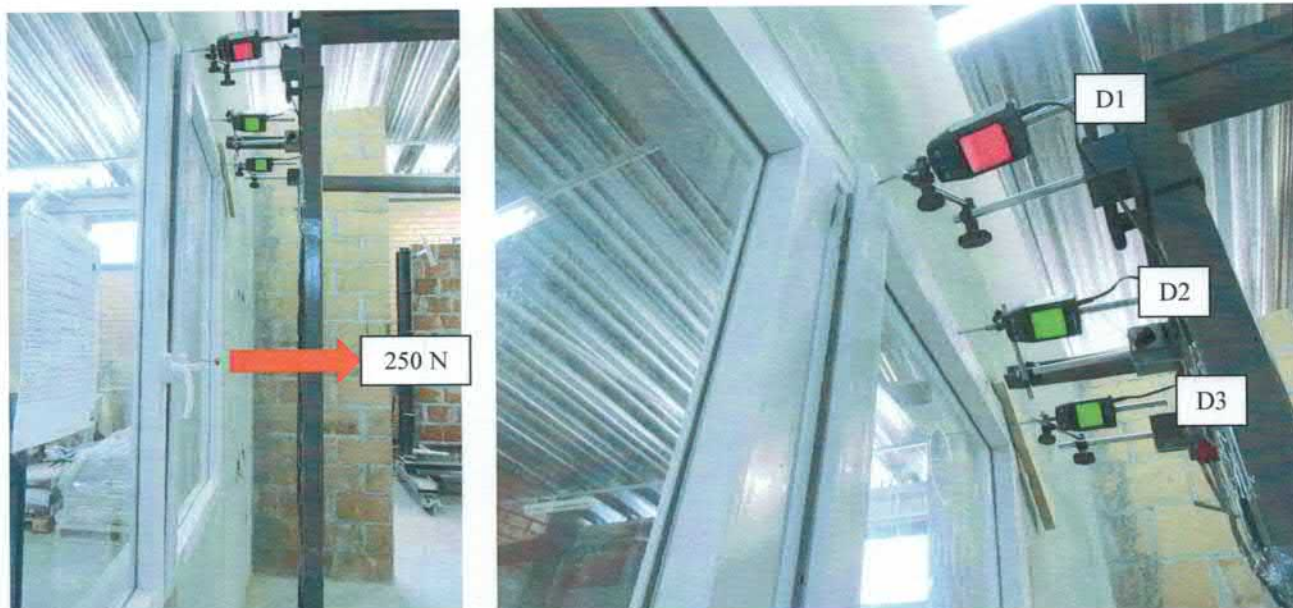
Figura 9 – Deformação máxima do perfil quando submetido ao esforço torsos no sentido de tomar
