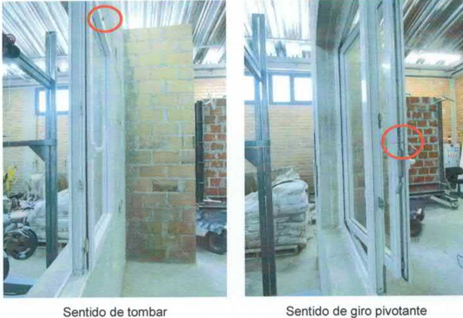
Figura 11 – Realização do ensaio de arrancamento das articulações
